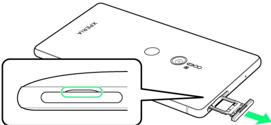
・ミゾに指先をかけて、SIMカード/SDカード挿入口のカバーをまっすぐに引き出してください。
